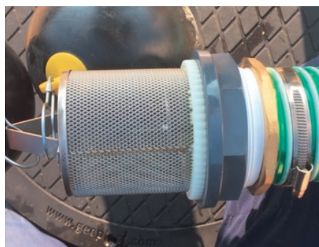
11. Edelstahldrossel wieder in PVC Mutter stecken und Filterkorb verschrauben.
