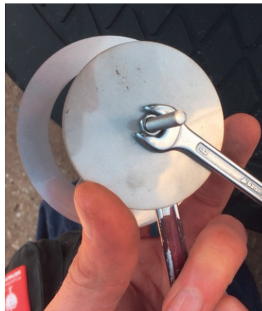
10. Beide Muttern mit Ringschlüssel (8) gegengleich anziehen.
