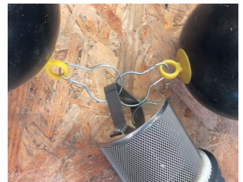
12. PE-Kugel(n) mittels Haken in Filterkorb einhängen.
