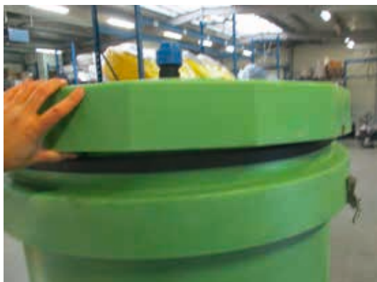
Schritt 21: Abdeckung zentrisch auf U-Profil Dichtung stecken
