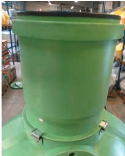
Schritt 17: Teleskopierbaren Domschacht auf Domschacht Aufsatz stecken. Niveau von Geländeoberkante beachten!!
