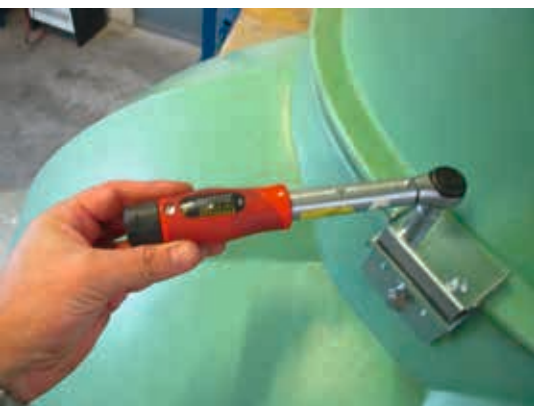
Schritt 15: Sechskantschrauben mit 80Nm anziehen
