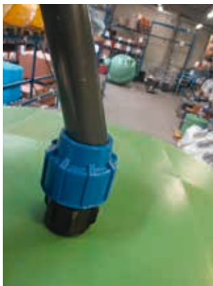
Schritt 25: Spitze des Belüftungsrohres mit dem Klemmverbinder verschrauben
