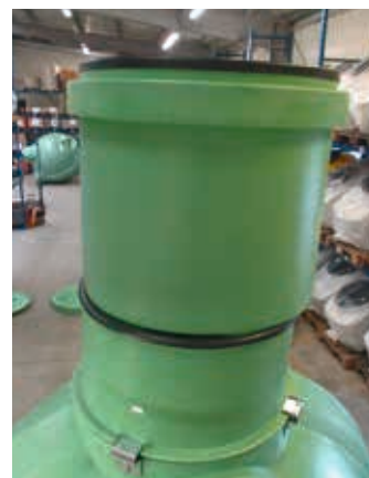
Schritt 16: Teleskopdomschacht über verschraubten Domschacht Aufsatz stecken
