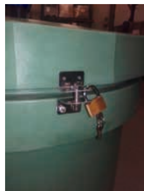
Schritt 27: Sicherheitsschloss an beiden Winkeln montieren
