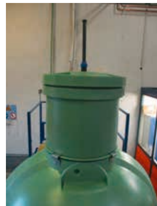
Schritt 26: montierter Domschacht
